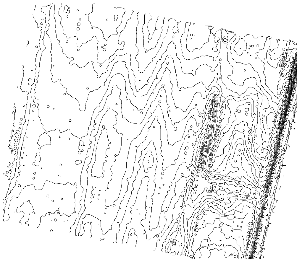
Mynd 4. Hólavellir. Hæðarlínur dregnar með u.þ.b. 5 cm hæðarmun eftir GPS-mælingu. Norður er upp.
